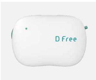
超音波センサーで膀胱の大きさを捉え、排尿タイミングをお知らせする世界初の排泄予測デバイス「D Free(ディー・フリー)」です。排尿前後のお知らせを事前に行うことで、トイレ誘導とおむつ交換の空振り削減や、利用者の自立排泄と失禁減少をサポートします。また、夜間の起き上がりを検知する機能も搭載されており、夜間の転倒予防にも役立ちます。
