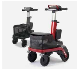
ハンドルに手を添えて歩くだけの簡単操作で、センサーとモーターを使ったロボット技術により坂道を上る時はパワーアシストで軽々と楽に、坂道を下る際には自動減速を行い、さらに手をハンドルから離すと自動ブレーキがかかるので安心、快適な歩行をサポート。又、通信機能を搭載、GPSとインターネットを利用した様々なサービスで歩行距離等の確認、「見守り機能」や「緊急通知機能」で離れて暮らす家族にも安心を提供。
