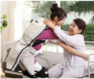
動きを検知してモーターでアシスト力の調整を可能とするアクティブタイプで、複合的な連続する作業動作に対応し、しっかりとしたアシスト感を提供。フレーム構造をもたない、ベルト巻き上げ式により大幅な軽量化を実現できました。介護作業における腰部の負担へ高い軽減効果。トイレ空間等での立位保持介助では59%低減、オムツ交換などの中腰姿勢保持では約94%低減を実現します。
